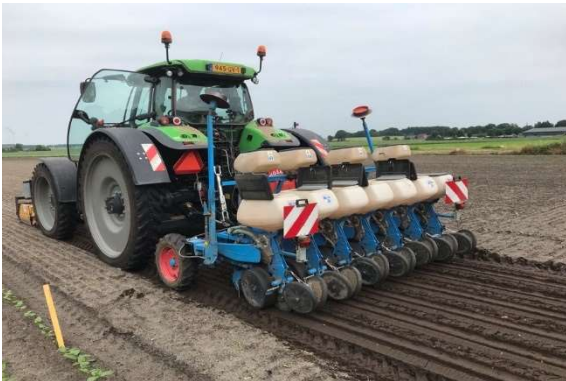
Foto 1: Zaaimachine, aandrukrollen omhoog zodat voortjes open bleven
