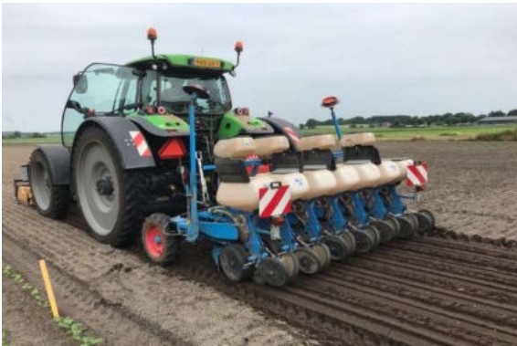
Foto 1: Zaaimachine, aandrukrollen omhoog zodat voortjes open bleven
